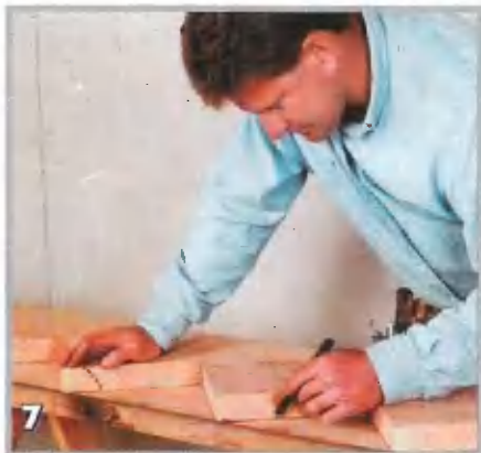
После проверки выкроенной тетивы по месту ее используют как шаблон для разметки второй тетивы
