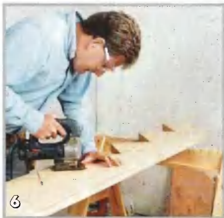
Окончательное выпиливание каждого угла делают лобзиком или ножовкой
