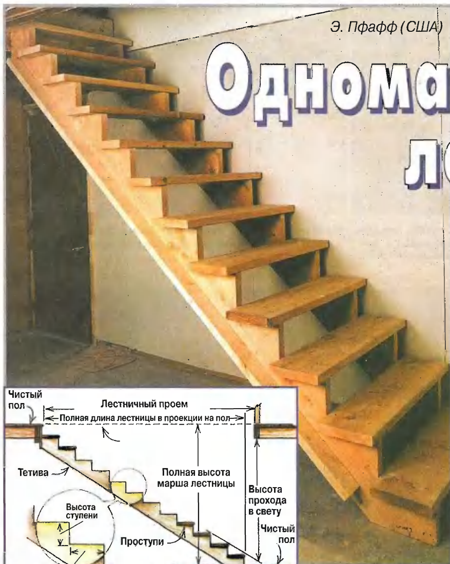
Рис. 2. Диаграмма соотношения между размерами ступеней и наклоном марша
