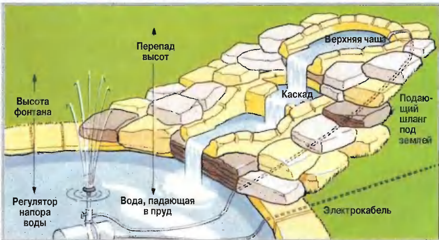
Рис. 1. Система замкнутого водооборота. И водопад, и фонтан приводятся в действие от погружного насоса. Ступени каскада устраивают так, чтобы вода нигде не уходила в землю
