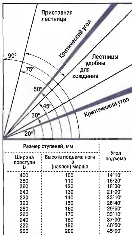
Рис. 2. Диаграмма соотношения между размерами ступеней и наклоном марша
