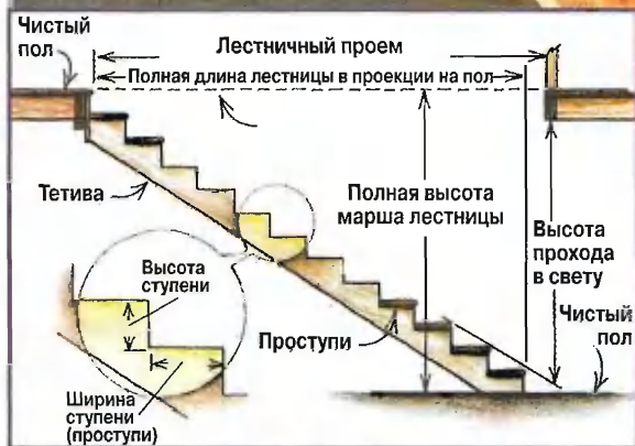
Рис. 1. Основные элементы одномаршевой лестницы
