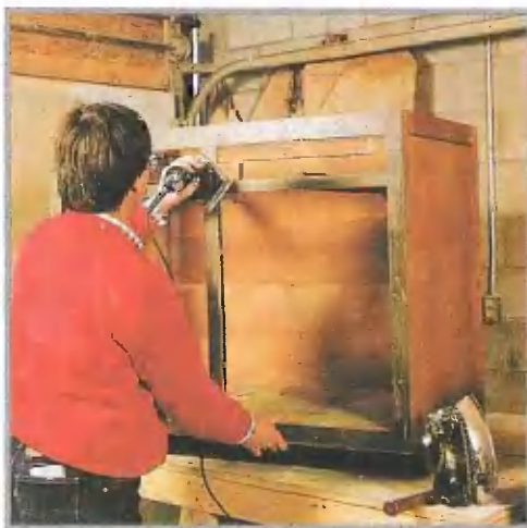
Первая операция — зачистка лицевых поверхностей каркасов мелкозернистой шкуркой
