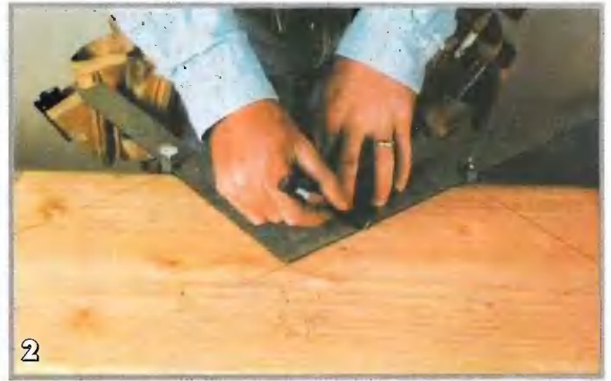
2 Маленькие зажимы, прикрепленные к треугольнику, позволяют разметить все ступени одинаковым образом
