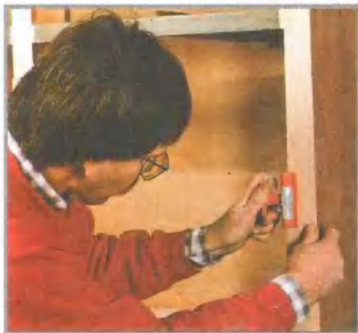
Выступающий за ребро каркаса шпон обрезают острым ножом по направлению волокон древесины
