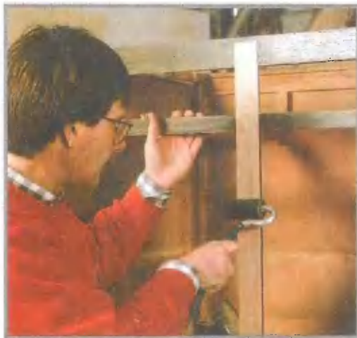
Еще горячие полоски фанеровки дополнительно прикатывают обрезиненным валиком
